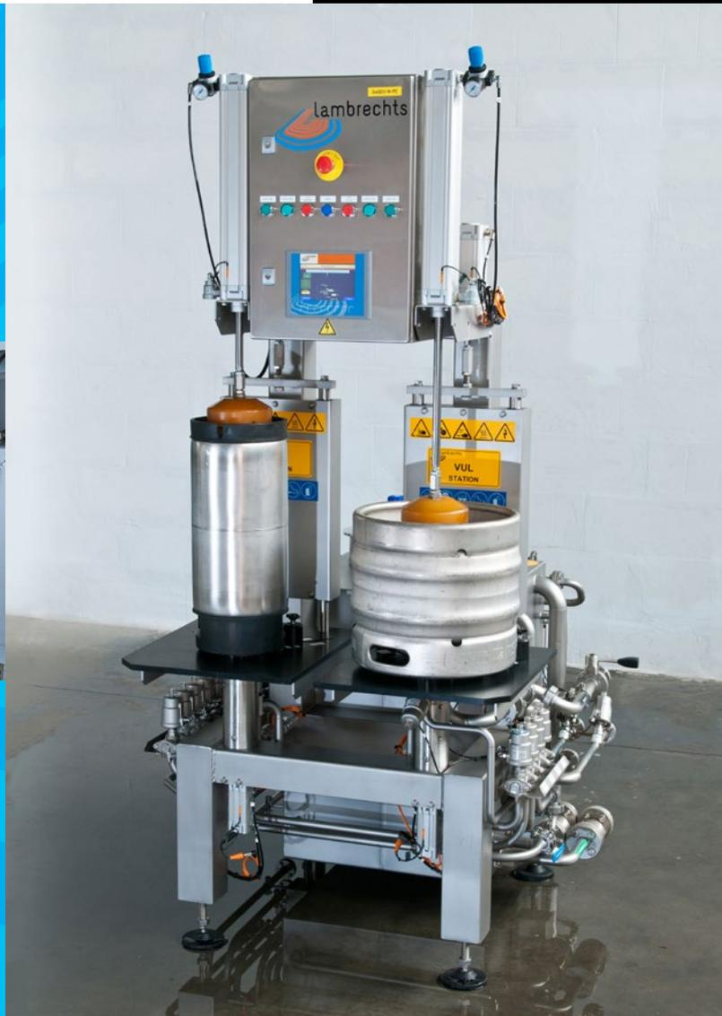
halfautomatische was- en vulmachine voor vaten
