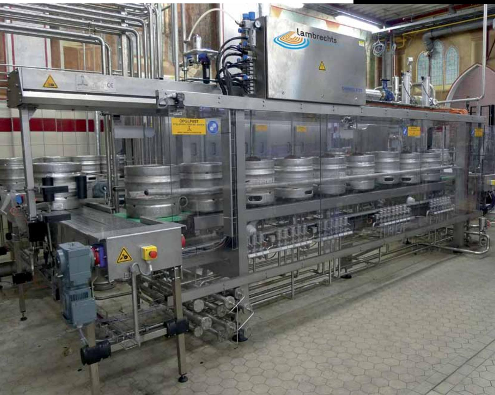
automatische was- en vulmachine voor vaten
